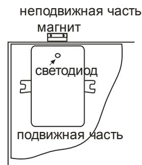
Рисунок 1. Пример монтажа
