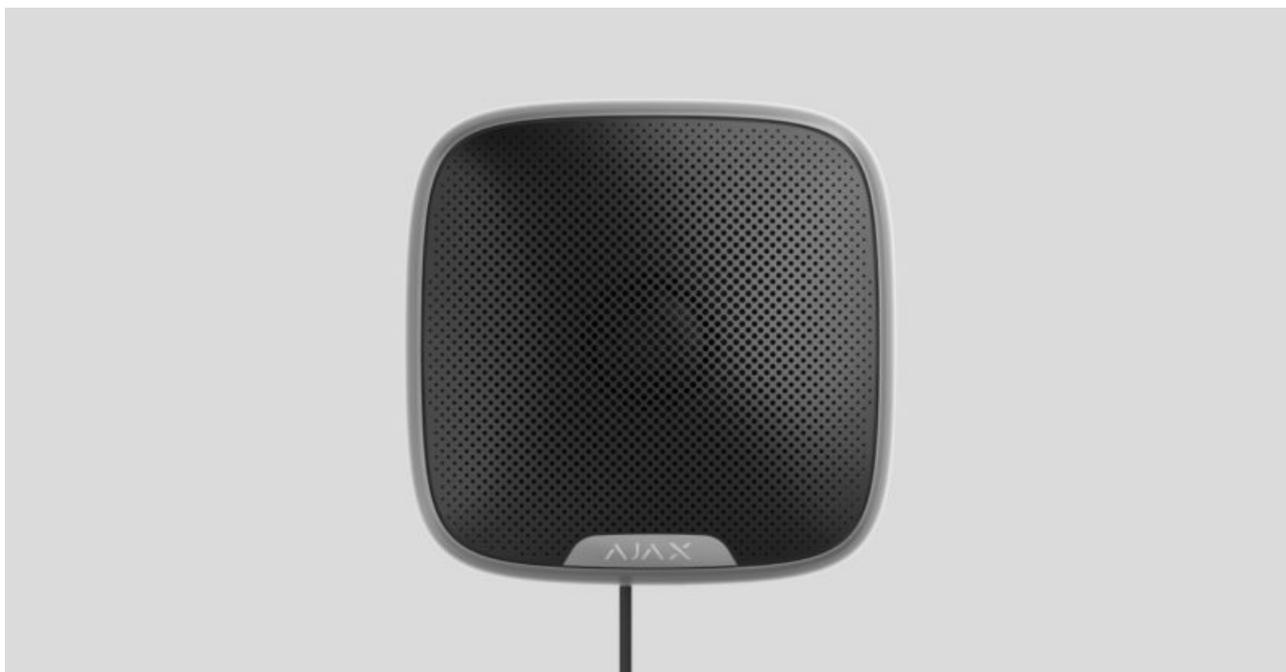
**StreetSiren Fibra** — проводная сирена системы безопасности Ajax. Оснащена LED-рамкой и пьезоэлектрическим извещателем, который может выдавать звук громкостью до 113 дБ. Устанавливается снаружи и внутри помещений.
